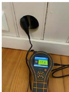
Fuktmåling i utforet vegg under terreng
