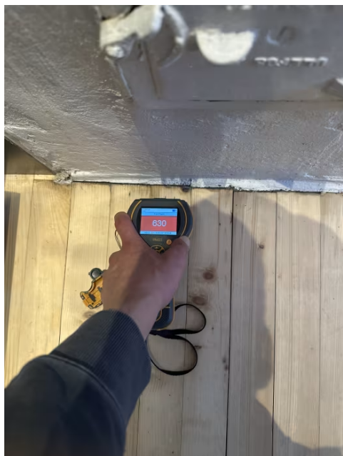
Det registreres fuktighet i tregulv rundt pipe.
