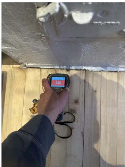
Det registreres fuktighet i tregulv rundt pipe.
