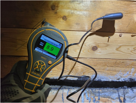
Fuktmåling i taktro uten unormale verdier.
