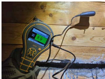
Fuktmåling i taktro uten unormale verdier.
