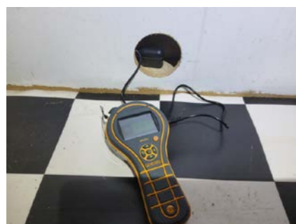
Fuktmåling mot vaskerom
