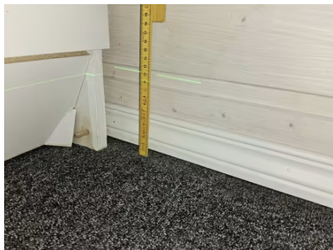
Kontrollmåling er utført med nivelleringslaser.
