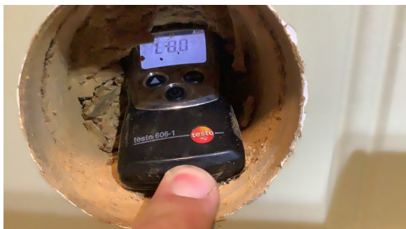
Hulltaking, og det måles tørt.
