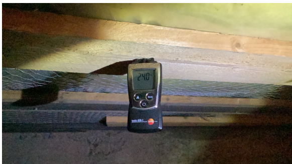
Fuktinnhold i treverk i kjeller på ca. 24 vektprosent.
