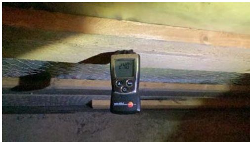
Fuktinnhold i treverk i kjeller på ca. 24 vektprosent.
