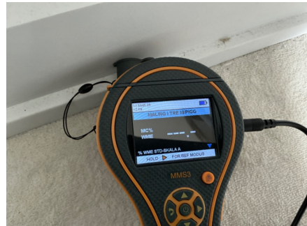
Måling av fukt i treverk. Målinger er foretatt fra inspeksjonsluke inne på soverom uten å påvise unormale forhold.
