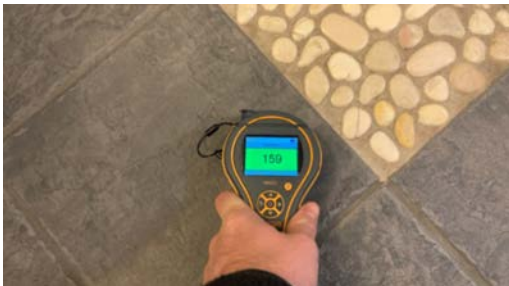
Fuktsøk på fuktutsatte områder
