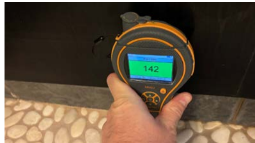
Fuktsøk på fuktutsatte områder
