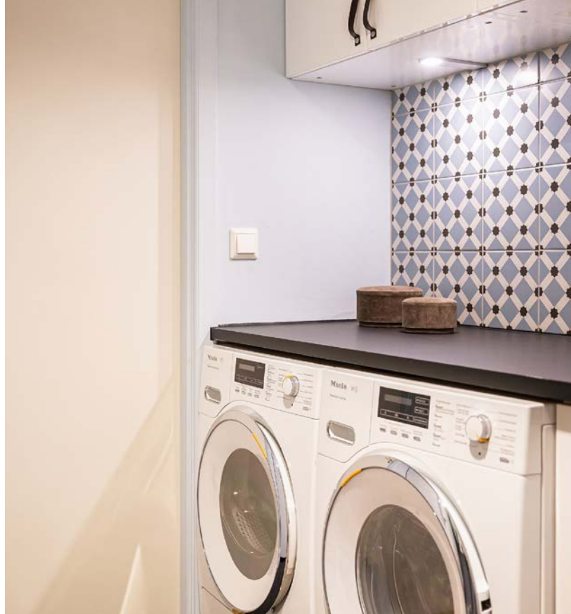
Rommet kan ikke defineres som vaskerom da det ikke er sluk i gulvet.
