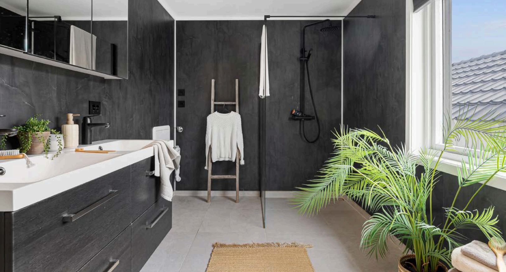
Stilig med med flislagt gulv og baderomsplater på veggene. Det er elektrisk gulvvarme.
