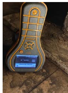
Fuktmåling i takkonstruksjon viste ingen forhøyede fuktverdier.
