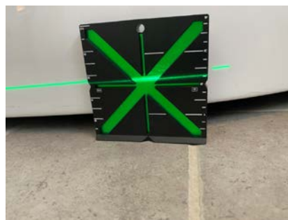
Måling av fall mot kabinett.
