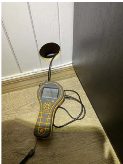
Hulltaking i tilstøtende rom.
