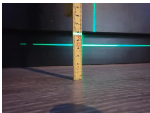
Referansenivå laser = 40 mm. Viser avvik på ca. 18 mm.
