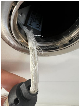
Slitasje/gnagd på ledning trolig fra mus/skadedyr
