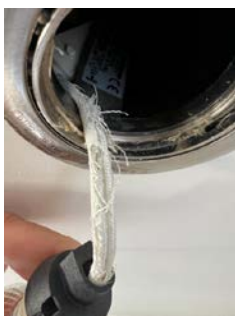
Slitasje/gnagd på ledning trolig fra mus/skadedyr
