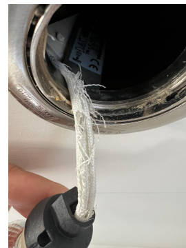
Slitasje/gnagd på ledning trolig fra mus/skadedyr
