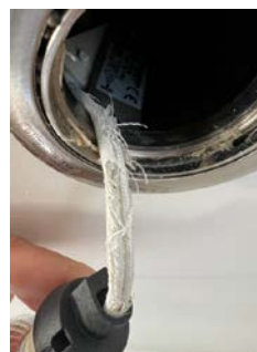
Slitasje/gnagd på ledning trolig fra mus/skadedyr
