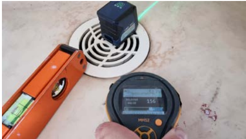
Fuktmåling og kontroll av fall mot sluk.
