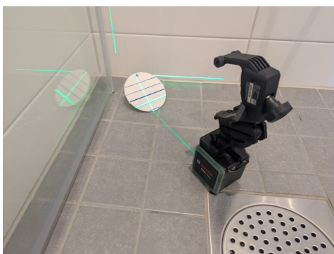
Måling av lokalt fall mot sluk
