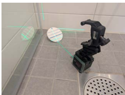
Måling av lokalt fall mot sluk
