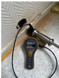
Måling med hammerelektrode i bunnline.
