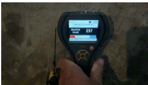
Høye fuktverdier i vegger registrert
