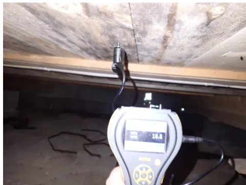
Fuktmåling viser et nivå med risiko for å utvikle mugg/svertesopp (18,8 vektprosent).
