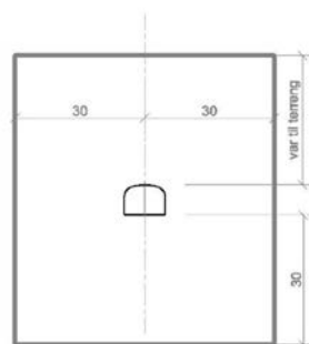
Rømnings tunnel/tverrslag med sikringssone 9,5x7m
