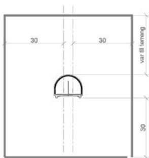
Jernbanetunnel med sikringssone
