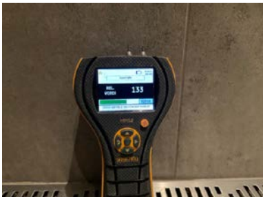
Fuktmåling på overflate i dusjsone
