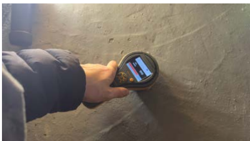
Det er påvist indikasjoner på fuktgjennomtrenging i kjellergulv.
