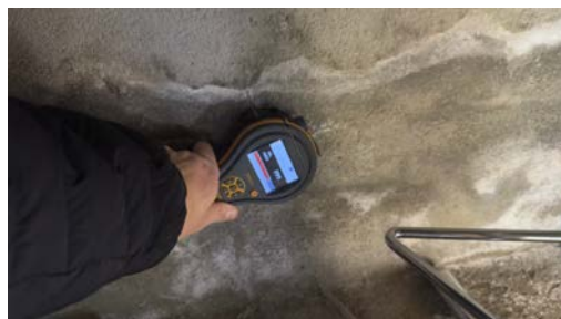
Det er påvist indikasjoner på fuktgjennomtrenging inn i kjellermur.
