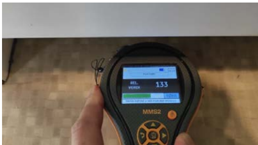
Fuktsøk rundt sluk.
