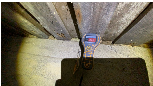
Bildet viser en fuktmåling på 22,9%
