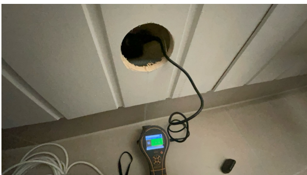
Hulltaking er foretatt i vegg mot grunnmur i kjellerstue.
