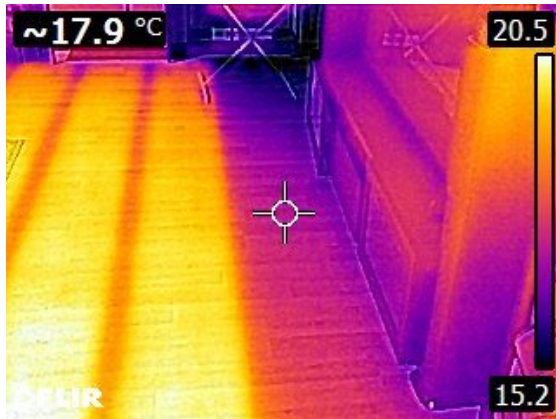
Bilde 1 Termogrammet viser tydelige folie striper og en jevn varme-effekt.
