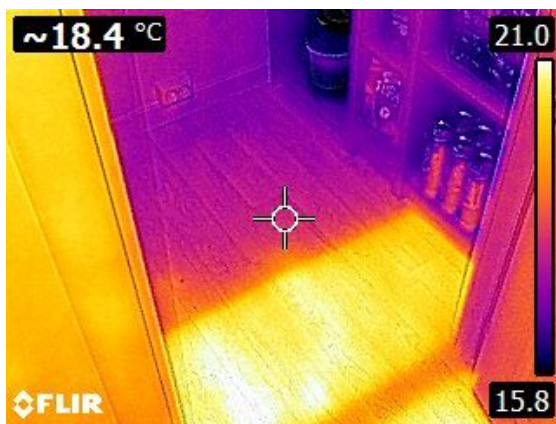
Bilde 3 Termogrammet viser tydelige folie striper og en jevn varme-effekt.
