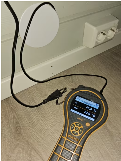
Bilde viser fuktmåling.
