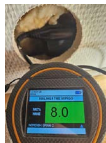
Måling av trefukt i lukket veggkonstruksjon mellom soverom og dusjsone.
