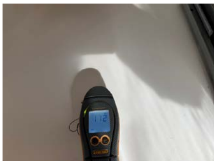
Ingen forhøyede fuktverdier ble registrert i kjøkkenbenken.
