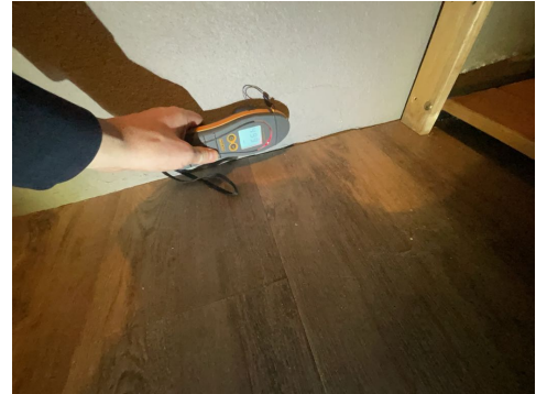
Fuktsøk økende mot gulv (kapilærøpsug)
