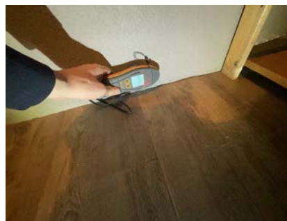
Fuktsøk økende mot gulv (kapilærropsug)
