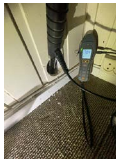
Hulltagning- normal fuktverdi, men avvik i konstruksjonsoppbygging (isopor og plastfolie).
