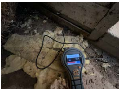
Høye fuktverdier i trevegg.
