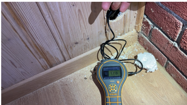
Hulltaking foretatt i innforet/innredet rom som er kjellerstue i vegg mot ytermur, ved fuktmåletaking var det fuktutslag
