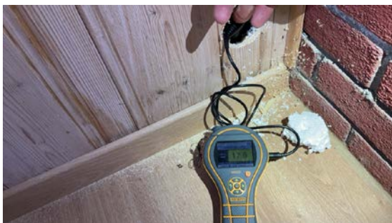
Hulltaking foretatt i innforet/innredet rom som er kjellerstue i vegg mot yttermur, ved fuktmåletaking var det fuktutslag
