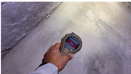
Fuktutslag på gulv på grunn
