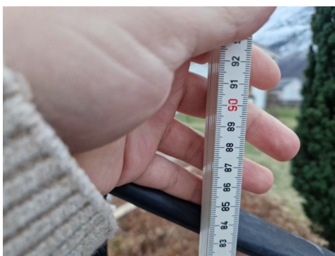
Rekkverk er målt til ca 84cm.
