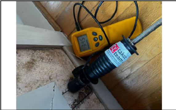
Fuktmåling av vegg. Det er også her man har en lokal nedbøyning i gulvet.
