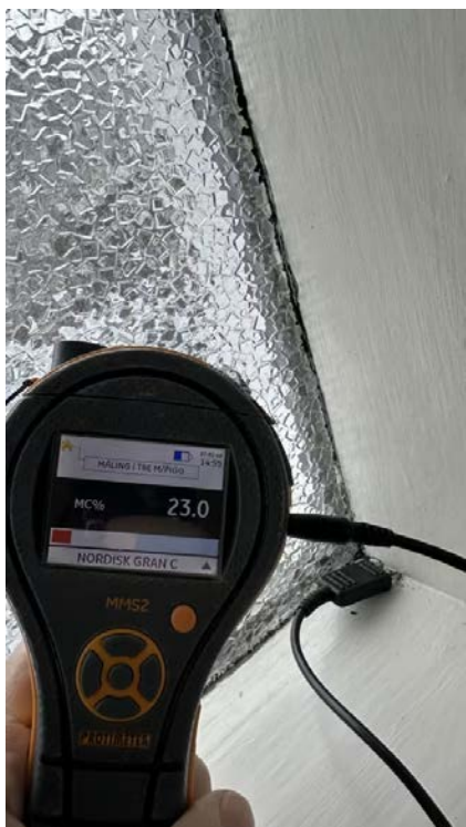
1.etasje - stue Høyere fuktverdier
