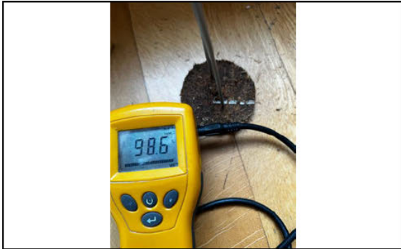
Fuktmåling av baksiden av platen på vegg.
