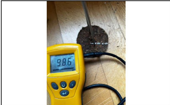
Fuktmåling av baksiden av platen på vegg.
