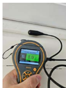
Referansemåling av trefukt i samme stakk ca. 2 meter bortenfor skadestedet.
