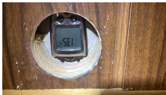
Hulltaking, og det måles tørt.
