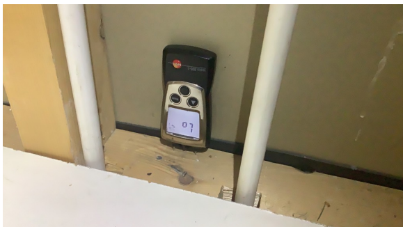
Fuktmåling, og det måles tørt.
