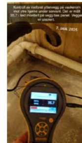
- TG 3 er gitt siden det målt 35,7% i innforet yttervegg mot ytre hjørne under servanten.
