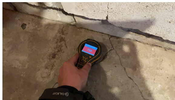
Med enkle fuktsøk i bod ble det registrert områder med forhøyede verdier.
