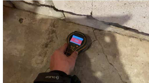
Med enkle fuktsøk i bod ble det registrert områder med forhøyede verdier.
