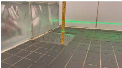
Målt fall til sluk: 18mm
