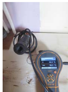
Fuktsøk fukt - Naturlige utslag - ingen forhøyede fuktverdier.
